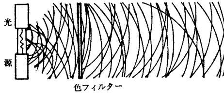
図 7 (b) 通常光から時間的コヒーレントな光を得る
